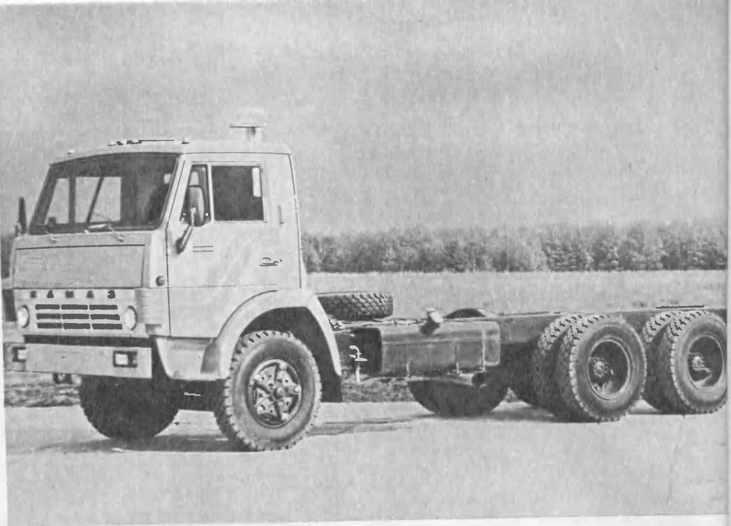
Длиннобазное шасси КамАЗ—53213 для оборудования и установок различного назначения.
