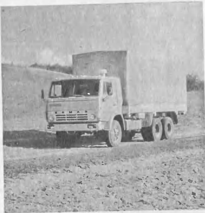
Длиннобазное шасси КамАЗ—53213 для оборудования и установок различного назначения.
